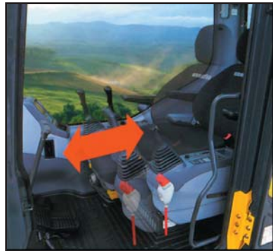
Величина перемещения сиденья в продольном направлении: 340 мм 13,4 дюйма, увеличена на 120 мм 4,7 дюйма
