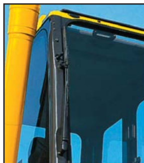
Стеклоочиститель, смонтированный на раме кабины
